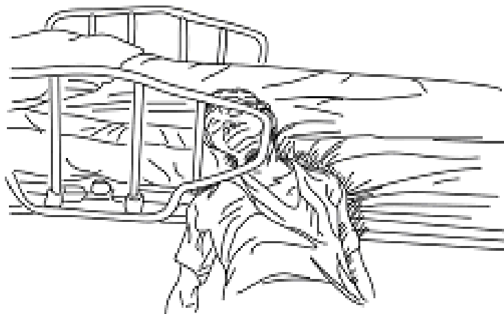
Ejemplo de un atrapamiento potencial – medida 6cm
